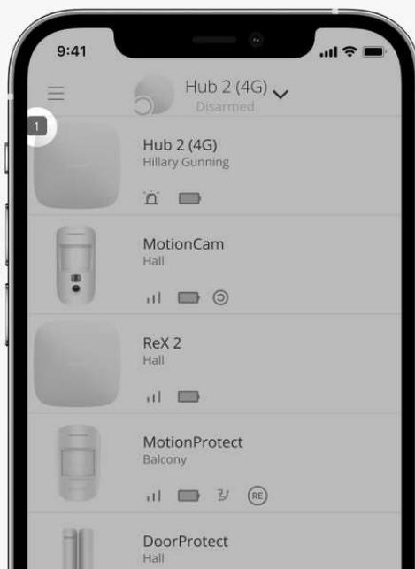
Si se detecta un fallo de funcionamiento del hub (por ejemplo, se ha perdido la alimentación externa), se muestra un contador de fallos de funcionamiento en el icono del dispositivo, en la app Ajax.
